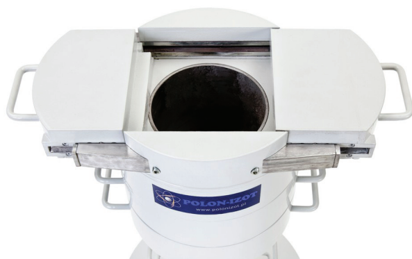
Widok komory pomiarowej.
