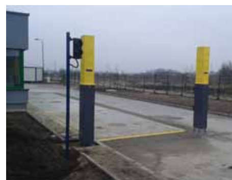
System monitoringu skażenia pojazdów kołowych i szynowych, w tym w ruchu pieszym
