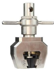
Uchwyt na rozciąganie Uchwyt na ściskanie Uchwyt na trzy punktowe gięcie Uchwyt na ścinanie
