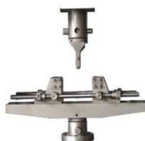
Uchwyt na rozciąganie Uchwyt na ściskanie Uchwyt na trzy punktowe gięcie Uchwyt na ścinanie
