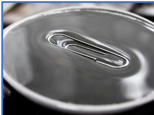
Napięcie powierzchniowe utrzymuje spinacz na powierzchni wody chociaż jego gęstość jest większa od gęstości wody
